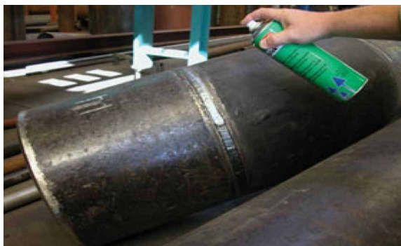
Рисунок 2 – Нанесение пенетранта на шов
